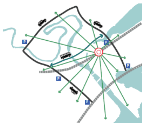
Styrke forbindelsene for gående og syklende ut fra knutepunktet og på tvers av barrierene. Parkering legges med adkomst fra ringveien.
