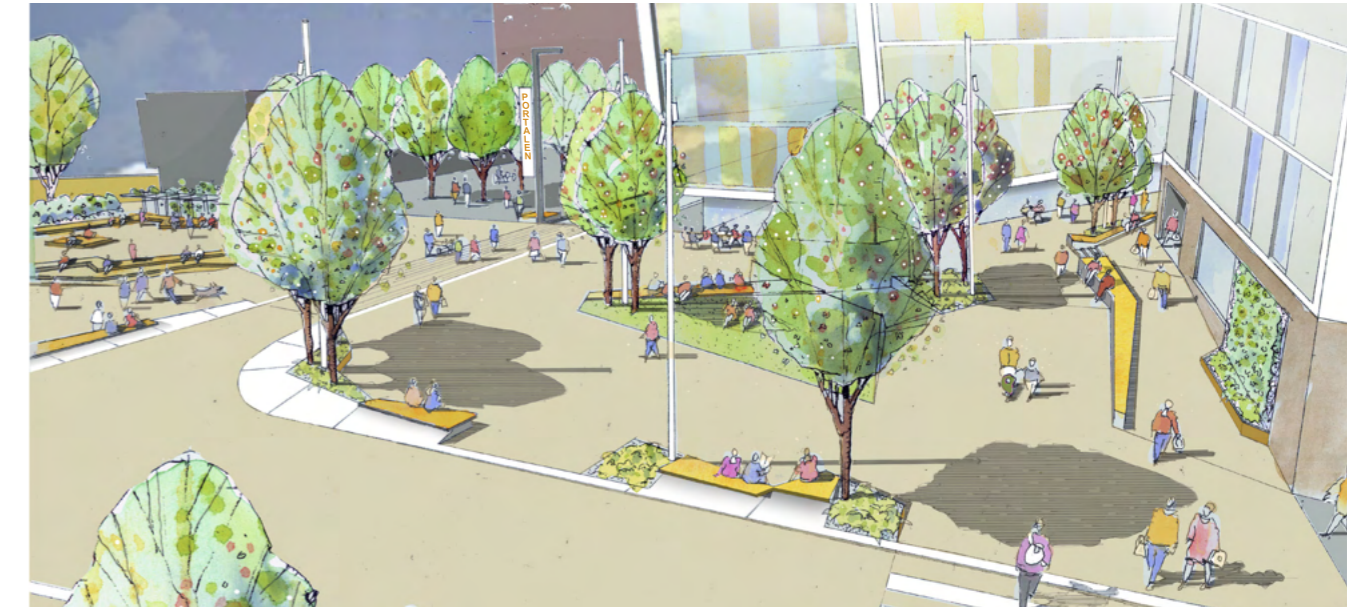
Eksempel på møblering som samtidig fungerer som avsperring for motorisert kjøretøy. Illustrasjon Bjørbekk & Lindheim
