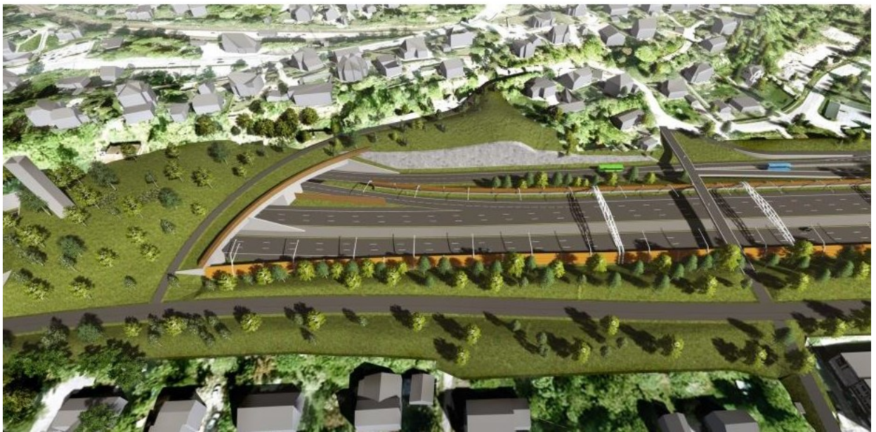
Miljøløkk over E18 og bussveien mellom Borgveien og Vesleveien. Ny gang- og sykkelvei på toppen av miljøløkket, samt i ny bro over E18 mot øst.
